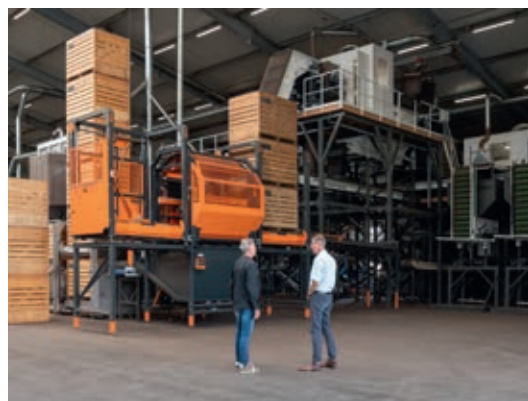
In de nieuwste loods staat de grote optische uien-sorteerder die met elektronische ogen en met behulp van Artificial Intelligence uien sorteert.
